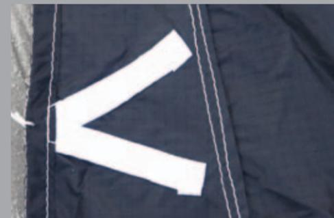
Verstärkung für die Waagepunkte am Flügelende
