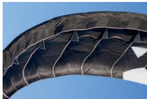
Trailing Edge Shaping durch Abnäher zwischen den Flexkielen
